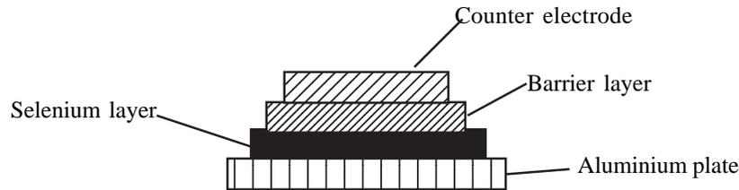
**Fig 7.5 Selenium Rectifier**
